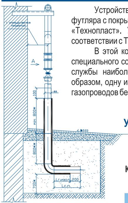
Устройство выхода газопровода из земли (УВГЗ) без футляра с покрытием на основе фотополимерных материалов «Технопласт». УВГЗ изготавливается АО «Гипрониигаз» в соответствии с ТУ 4859-068-03321549-2011.
